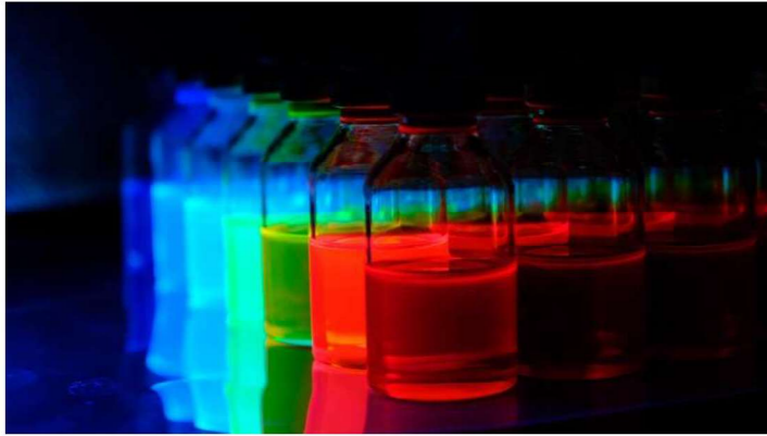
伊勢化學工業股份有限公司 (日本, 東京) 生產的發光鈣鈦礦量子點。
